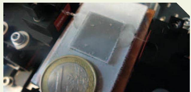
Sensor en proves que s'està desenvolupant per incorporar a les ales dels avions.
