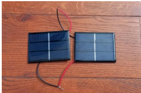
Il·lustració 37. Panells solars de 1.5V connectats en sèrie
