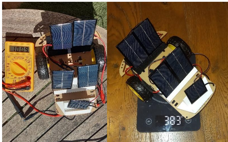
Il·lustració 69. Imatges que mostren el voltatge entregat pels panells solars i el pes total del prototip. Font: pròpia.
