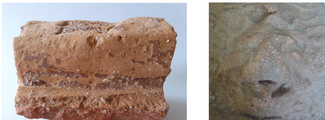
Massa argilosa amb inclusions vermelles, blanques i fragments de mica.
