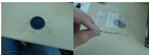
Figura 8: Nafion MEA (Membrane electrode assembly). Font pròpia
