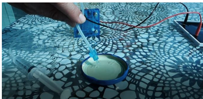
Figura 22: Producció d'hidrogen de l'electrolitzador PEM. Font pròpia
