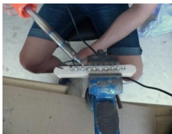
Figura 18: Soldant cables a l'electrolyzer. Font pròpia.
