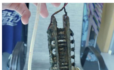
Figura 32: Òxid format amb l'electrolitzador alcalí. Font pròpia
