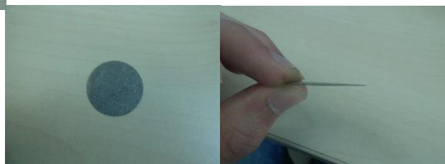
Figura 7: Elèctrode de platí. Font pròpia
