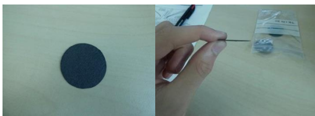
Figura 6: GDL de carboni (Membrana de difusió de gas). Font pròpia
