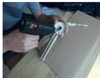
Figura 19: Recobrint amb silicona les fugues de gas. Font pròpia.
