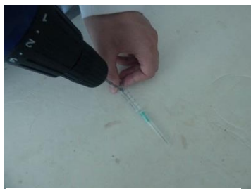
Figura 11: Xeringa foradada amb un trepant. Font pròpia
