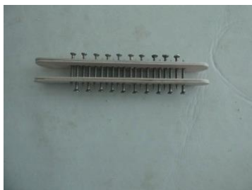
Figura 17: Electrolyzer realitzat. Font pròpia.
