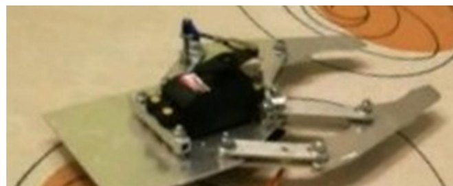
Imatges del primer prototip de pinça, incorporada al braç i en detall.
