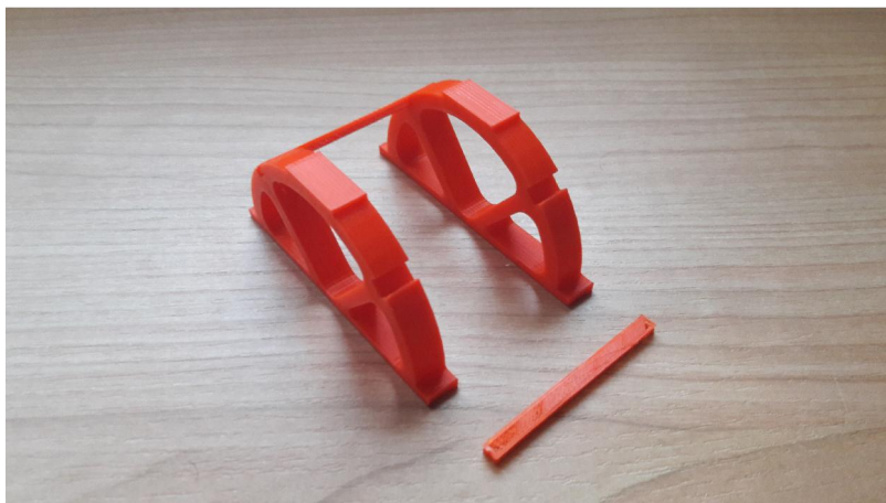
Suport del servo-motor imprès en 3D.
