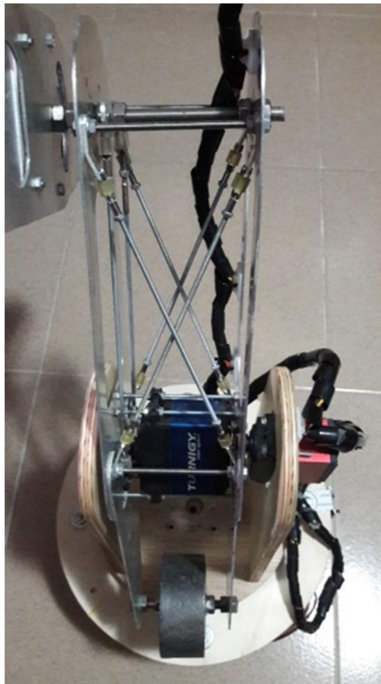
Imatge dels tirants que donen rigidesa a l'estructura.
