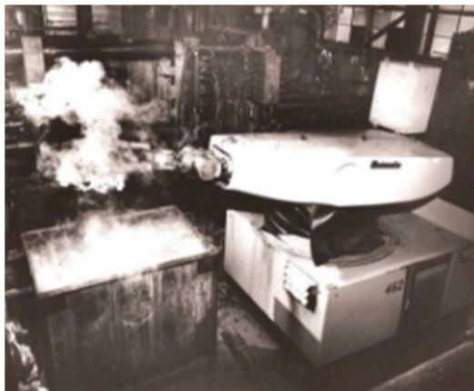
Primer robot industrial, treballant en una aplicació de fundició per injecció
