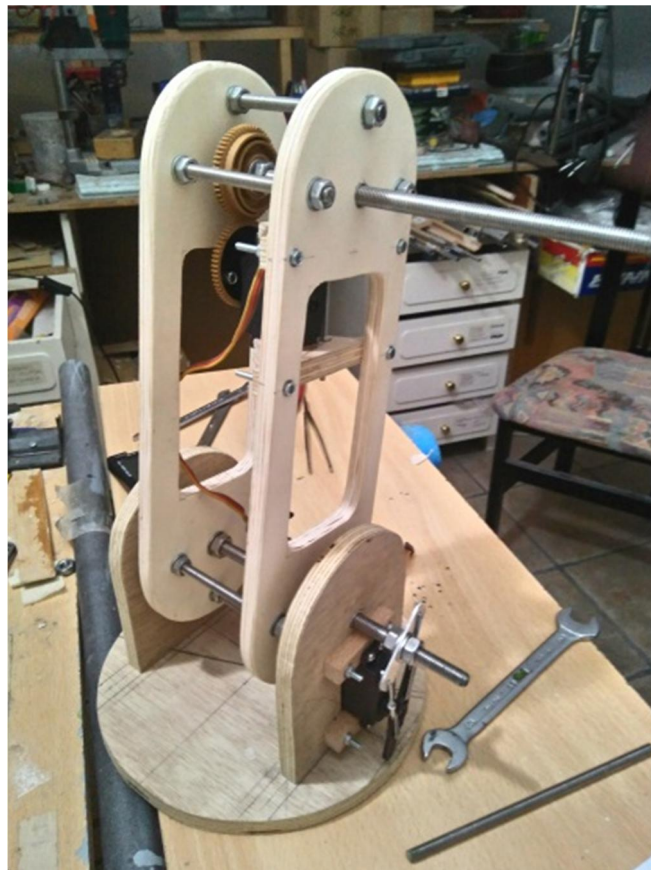
2n prototip amb transmissions d'engranatge i varetes.
