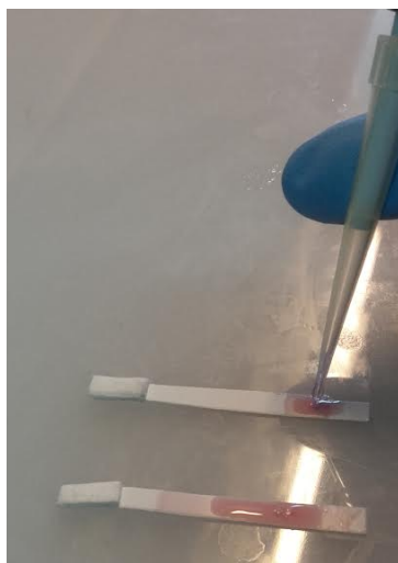
Figura 53. Mitjançant una pipeta graduada en una tira s'aboca la solució positiva i en l'altra tira s'aboca la solució negativa. Les solucions avancen fins el final de la tira per capil·laritat.
