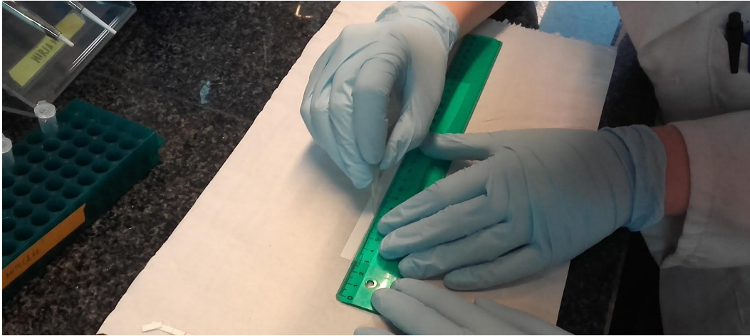
Figura 48. Es va traçar sobre la membrana de nitrocel·lulosa la línia de test mitjançant la punta de la pipeta que contenia la solució corresponent.
