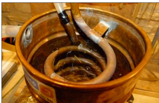
Serpentí dins del refrigerant
