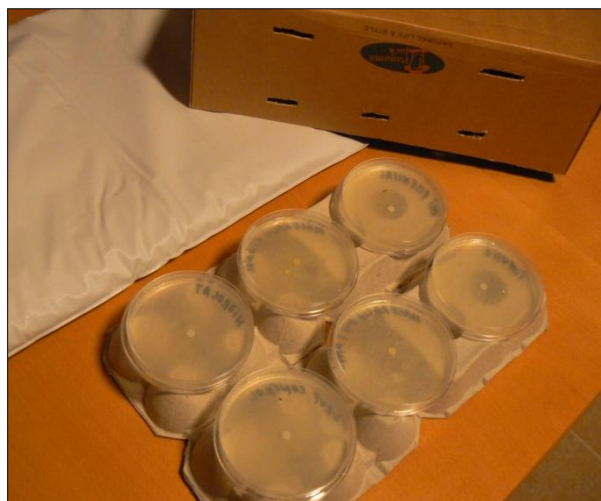
Manta elèctrica, capsa amb petits forats i plaques de Petri disposades sobre oueres tallades per la meitat
