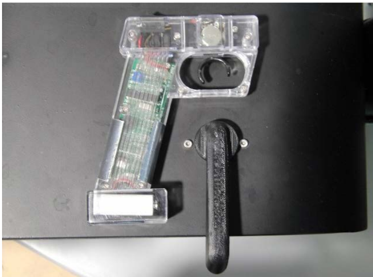
Imatge 8. Control remot de velocitat del sistema TwinDolly.
