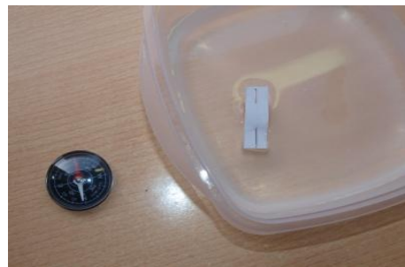
Figura 25: Comparació entre les agulles, totes dues apunten en la mateixa direcció. Resultat pràctica 5
