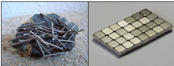
Figura 1: A la esquerra, imant natural. A la dreta, imant artificial. Fotos extretes de https://webs.um.es/matias/miwiki/doku.php?id=galeria i http://commons.wikimedia.org/wiki/File:Nd-magnet.jpg
