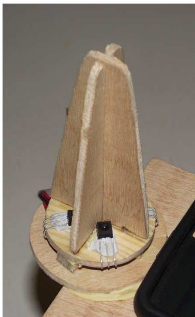
Imatge 21: Sistema de sensors TSOP4038, per efectuar el seguiment
