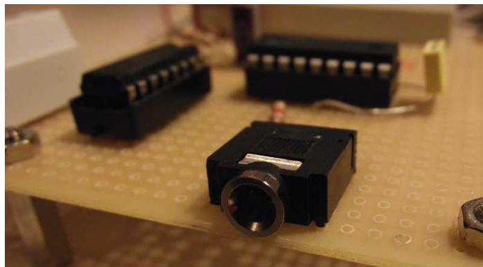
Imatge 18: Connector Audio Jack (davant), microcontrolador PICAXE18M2 (darrere) i L293DNE (esquerra)
