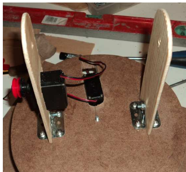
Imatge 13: Braços superiors fixats a la base giratòria
