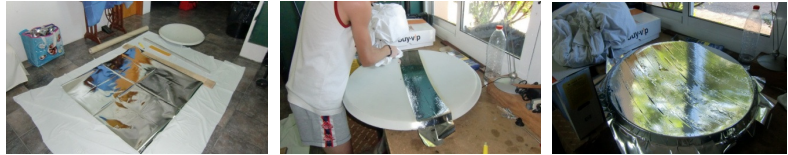
Diferents etapes folrat paràbola amb paper reflectant efecte mirall
