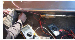
Temperatura en la cèl·lula-69ºC i Tª xapa exterior 24ºC (esquerra)
