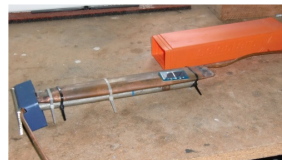
Tub de coure refrigerat per aigua amb la cèl·lula
