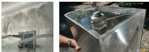
Detalls d'envelliment diferents parts de les cèl·lules solars del mòdul M40 comprat
