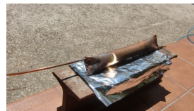
Concentració solar amb miralls enfocant el tub de coure
