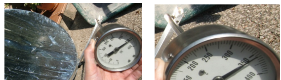
Màxima temperatura en la paràbola folrada amb paper reflectant sense fixació ni seguiment
