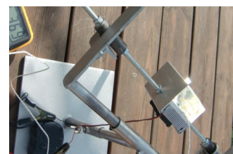
Mòdul enfocat amb sistema refrigeració per aire
