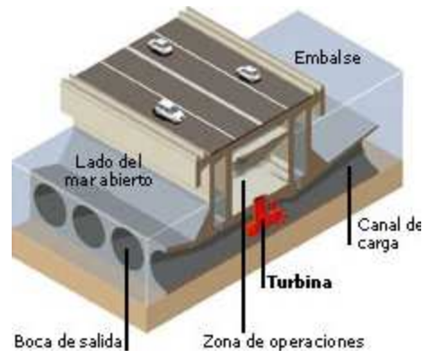
Funcionament central mareomotriu
