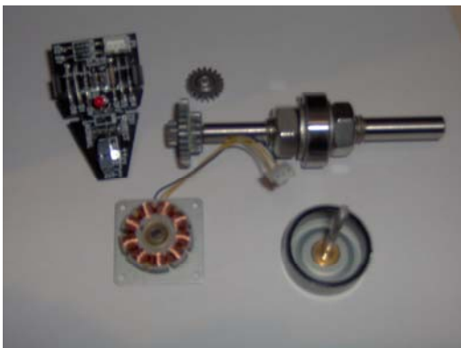
Fig. 35 Eix, motor i rectificador
