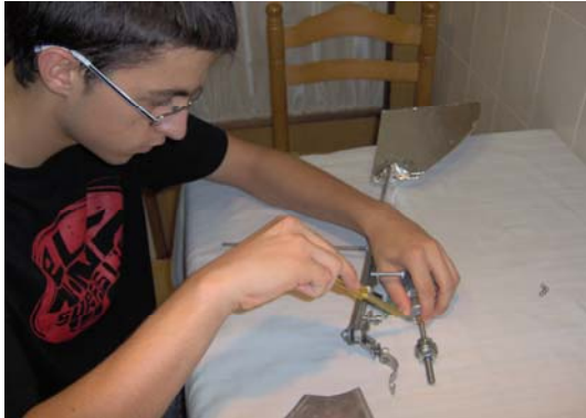
Fig. 37 Acoblant l'eix a la gòndola
